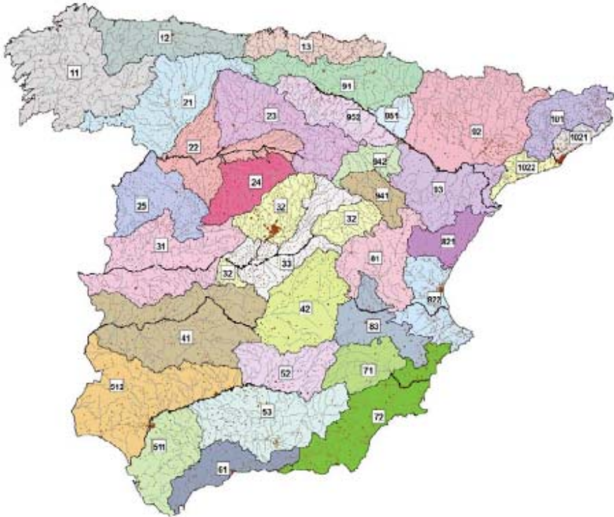
Figura 13. Rexións consideradas para a caracterización do coeficiente corrector do limiar de escorrentía (fig. 2.9 Instrución 5.2-IC)
